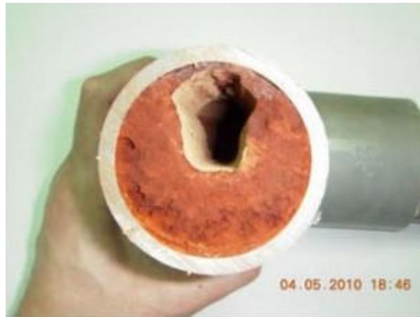
Rury instalacji często całkowicie były blokowane przez osady mineralne
