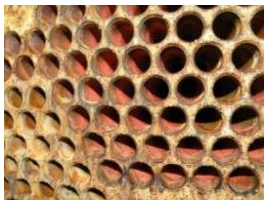
Dno sitowe wymiennika po trzech miesiącach funkcjonowania systemu HydroPath. Na powierzchni widoczny delikatny pyłek zamiast twardych osadów mineralnych.
